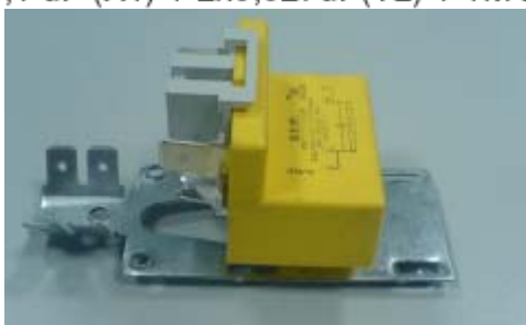
Condensateur Anti-parasite 0,1 µF (X1) + 2x0,027µF(Y2) + 1M Ω
