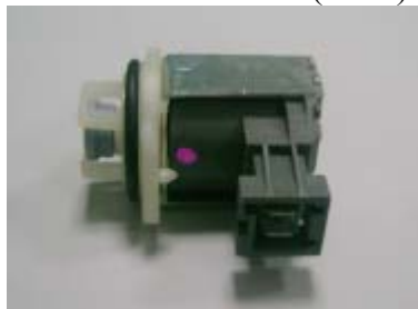
Electrovanne régénération 6W – 4130 ±10ohm (25C°)
