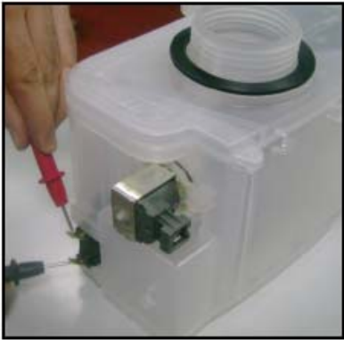
0 Ω (sans sel) et ∞ Ω (avec sel)
