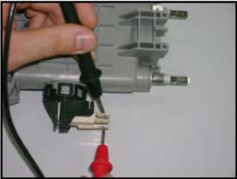
0 Ω (avec eau) et ∞ Ω (sans eau)
